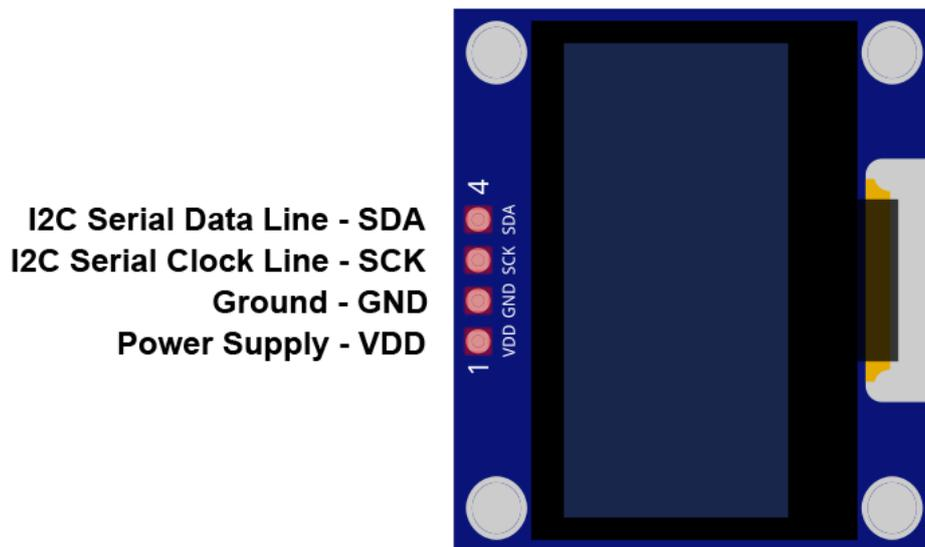
La pantalla incluye un regulador de voltaje. Los pines de la pantalla OLED de 1.3 pulgadas se pueden conectar a una fuente de alimentación de 3.3V o 5V sin peligro para el propio sensor.
