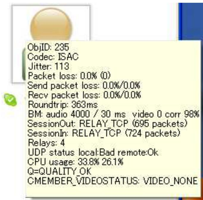
図 6.12: iptables と NEC の組み合わせで TCP-RELAY 通信中の画面
