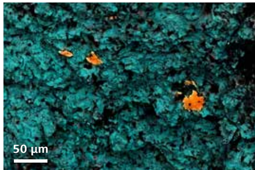
断裂样品的 EDS 图：在铁（蓝色）背景中呈现锌（橙色）碎片。样品由美国 Harvard University 大学细胞分子生物系的 J. Scott 提供。
