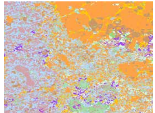
高分辨率矿物分布图。镍铜矿、弗雷则镍矿和萨德伯里矿。图片由英国 University of Leicester 提供。
