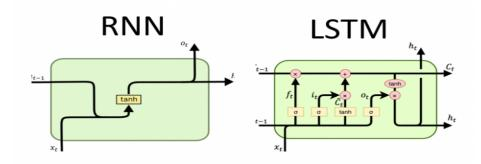
Entonces, analizando un poco más en detalle las redes LSTM, se puede ver que contienen una celda de RNN simple, una sección de memoria a corto plazo, que se encarga básicamente de lo que está pasando en el estado actual y finalmente una "Cell State" que es la marcada abajo.
