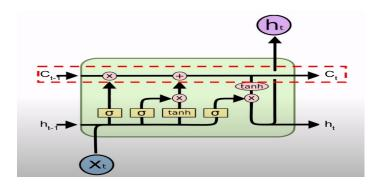
La Sección "Cell State" se encarga de guardar los patrones de largo plazo, se actualiza solo en 2 puntos en una neurona:
