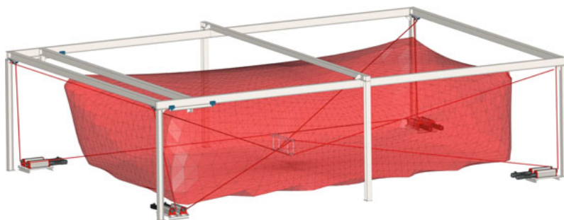
شکل ۲.۲: نمونه‌ای از فضای کاری محاسبه شده برای ربات کابلی موازی IPaNema 3 [۶۳]
