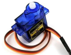
מנוע סרוו : לפתוח ולסגור את השער של החניון בעזרת נתונים של חיישן מד מרחק
