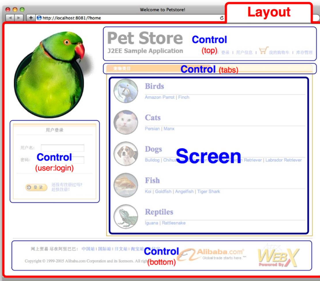
图 4.2. Webx Turbine页面的构成
